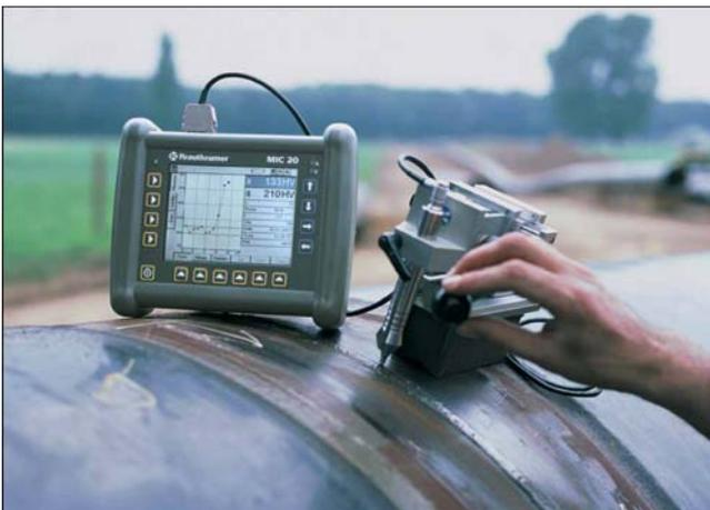
**Slika 1:** Ispitivanje tvrdoće s MIC 20 u kombinaciji s potpornjem MIC 227 i UCI sondom u zoni utjecaja topline (ZUT) na zavarenom spoju.
