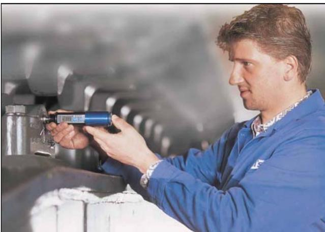
**Slika 3:** Ispitivanje tvrdoće s DynaPOCKET na lancu stroja za iskapanje u otvorenom kopu.
