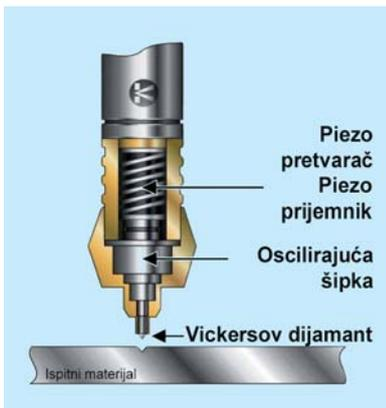
**Slika 5:** Shematski prikaz UCI metode (Ispitno opterećenje/oscilirajuća šipka/Vickersov dijament/materijal za ispitivanje)
