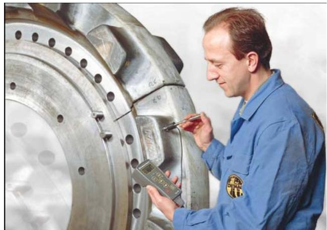
**Slika 2:** Ispitivanje tvrdoće metodom odskoka (DynaMIC) na pogonskom kotaču velikog hidrauličnog rovokopača.
