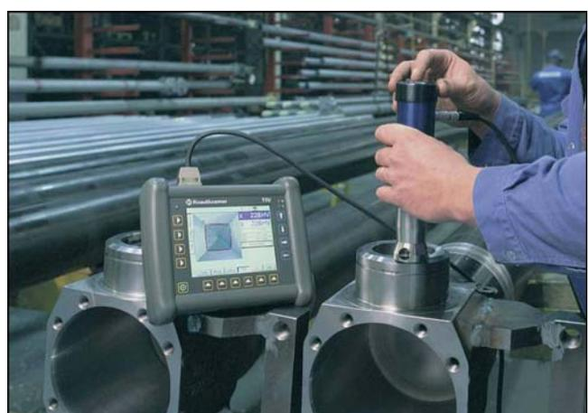
**Slika 4:** Optičko ispitivanje tvrdoće TIV mjeracom. Provjera prije završnog sklapanja.
