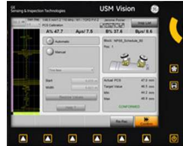
3. Pozicija sondi sada udovoljava kriterijima. Operater može prijeći na slijedeći korak.
