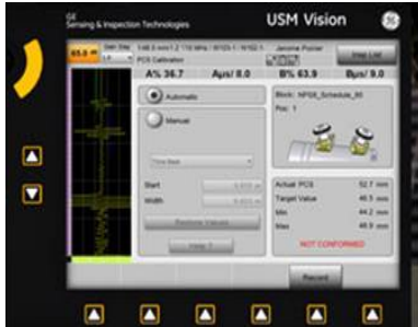
1. Pozicija sondi ne udovoljava zahtijevanom kriteriju
