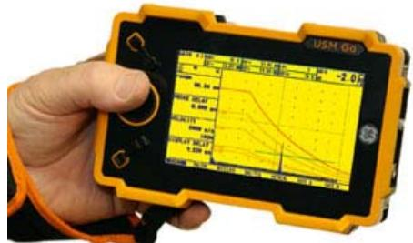
USM Go je najlakši prijenosni ultrazvučni uređaj za detekciju grešaka u materijalu u assortimanu GE-a. USM Go je konstruiran za lakše i dugotrajnije korištenje u najtežim uvjetima ispitivanja u naftnoj industriji, zrakoplovstvu, brodogradnji, energetici, automobilskoj industriji i ostalim industrijskim granama.
