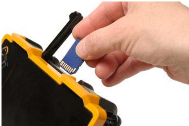
Standardni USB port omogućuje prijenos podataka sa uređaja u osobno računalo za daljnu analizu ili pohranu. U standardnoj isporuci nalazi se 2 GB memorijska SD kartica (zamjenjiva sa karticom do 16 GB).
